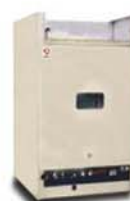
NORMACEL Cassette, compartimento com disjuntor de vácuo extraível e seccionador de terra NORMACEL Cassette, Module with draw-out vacuum circuit breaker and earthing switch. Até | up to 17.5kV / 24kV Até | up to 2500A / 2000A Até | up to 40kA / 25kA
